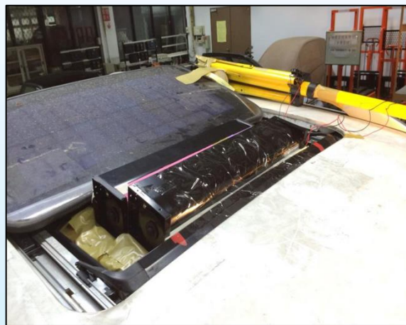
改良後散熱裝置(加大風量)
